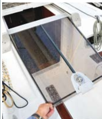
OCEANIS: Lemmen foran nedgangen skyves elegant vekk under luken. Men, når det er tøff sjø kan ikke åpningen delvis lukkes.
