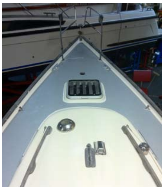
Däcket med två lager gelcote ...
