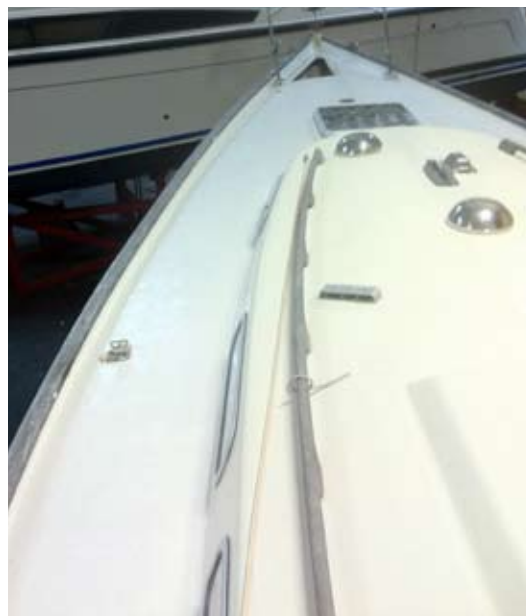
Däcket med två lager gelcote ...
