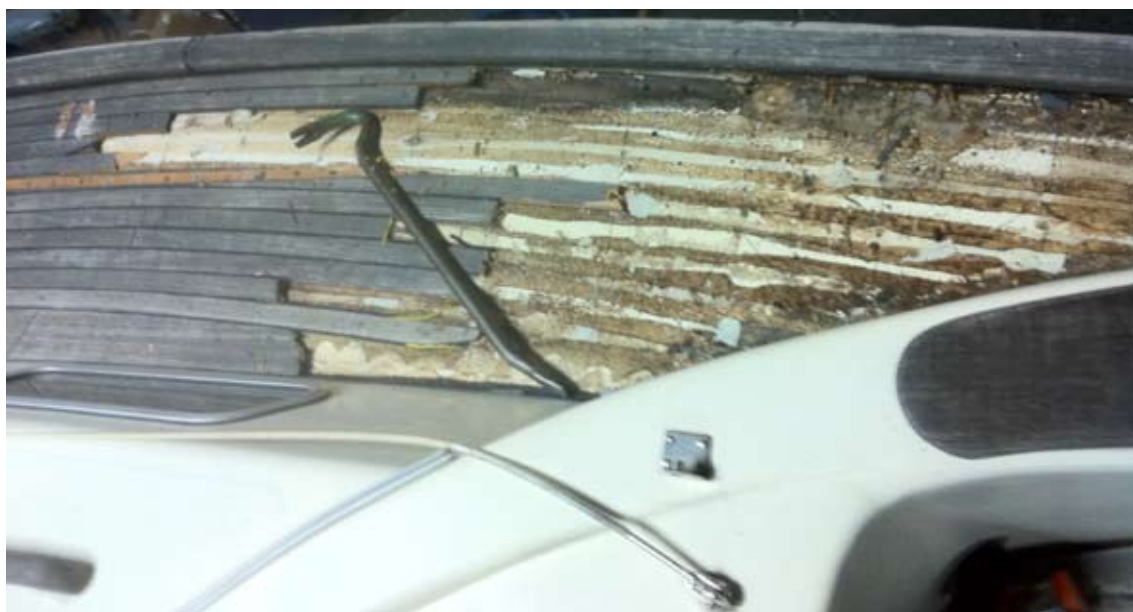
När skruvarna hade lossats var det lätt att bryta loss teakdäcket.
