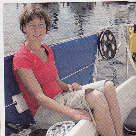
Sargkanterna lutar och avståndet till mantåget är väl avvägt.
