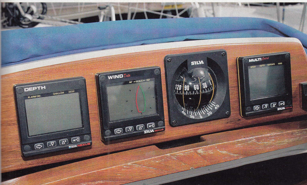
Välplacerad instrumentpanel ovanför nedgångsluckan.
