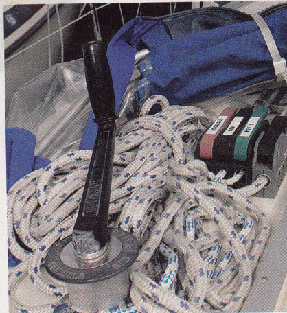
Fall och trimlinor är dragna till rufftaket och lätt nåbara från sittbrunnen.
