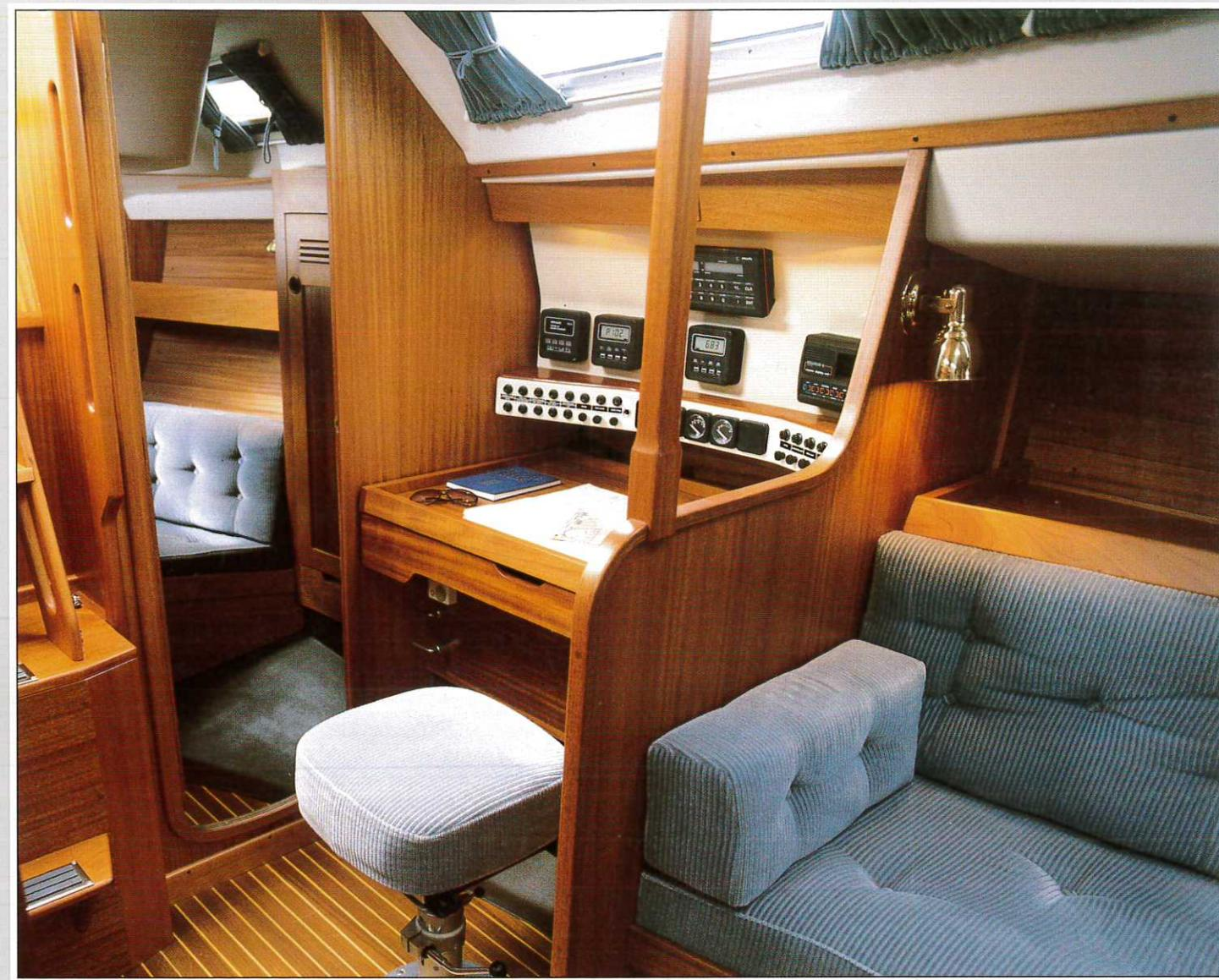
Navigationsplatsen är rymlig och exemplariskt översiktligt. Instrumentpanelen är fällbar och ger total åtkomlighet för service och kontroll. Separata utrymmen finns för småprylar, navigationsutrustning och sjökort. Skepparens favoritplats!
