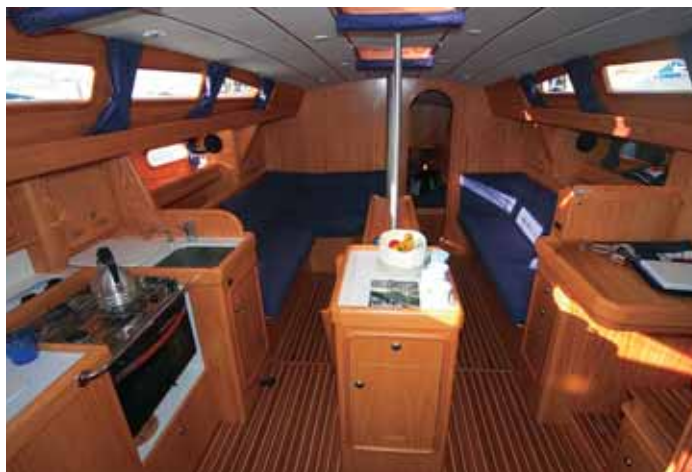
EIK: Aluminiumsbåt med mye treverk under dekk. Eik gir særpreg. Senkekjølen kommer opp i bordet.
