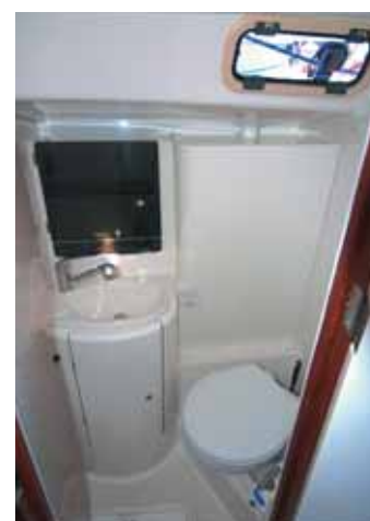
Toalettskålen er plassert 45 grader .
