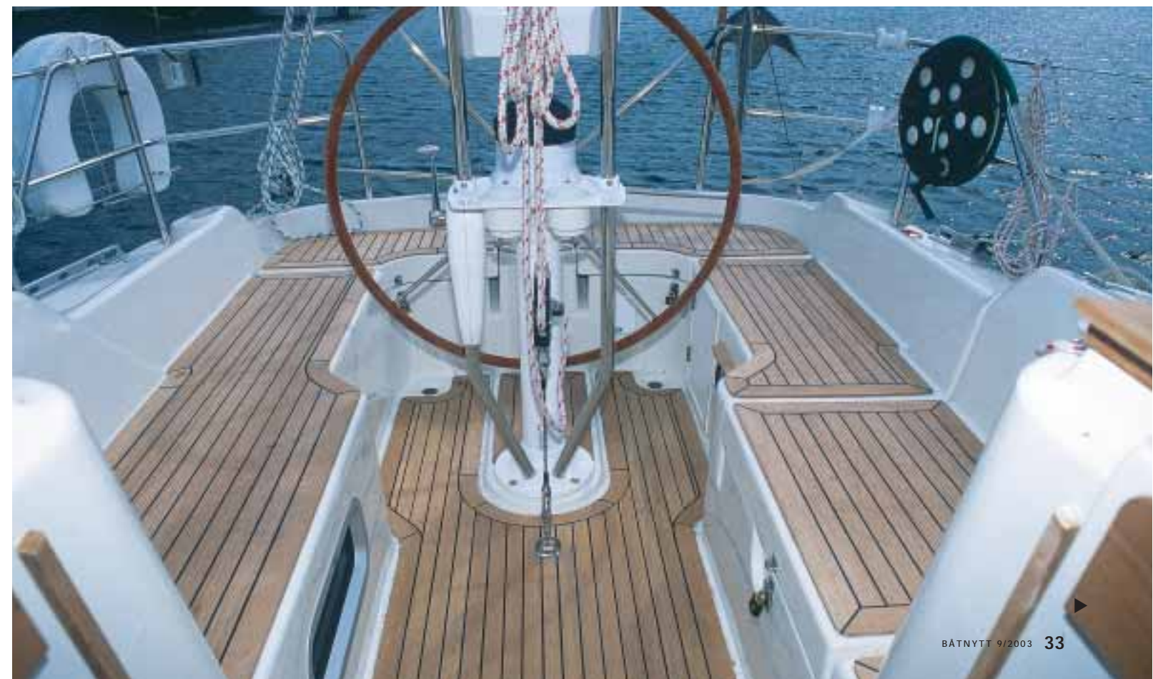
Sittbrunnen är välplanerad för aktiv segling. Rattstyrningen stjälar dock onödigt med plats. Bättre är rorkult som är standard.
