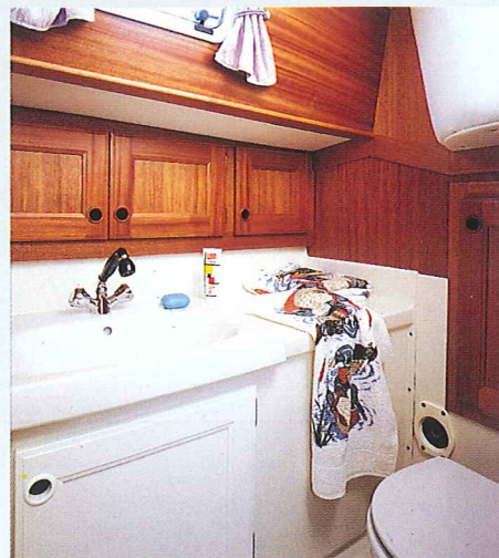
Der geräumige Waschraum bietet Komfort fast wie zuhause. Das Waschbecken ist aus Porzellan. Schränke und Stauraum sind auch hier sehr großzügig bemessen. Den Fußboden bildet eine Duschwanne mit einem Teak-Lattenrost über dem Abfluß. Es gibt einen separaten Ölzeugschrank mit Abfluß, der auch vom Cockpit aus zugänglich ist.
