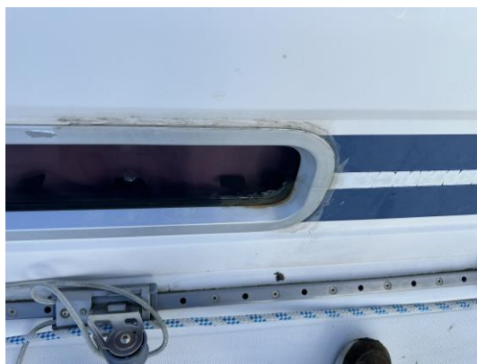
Spår av provisorisk tätning av ventil
